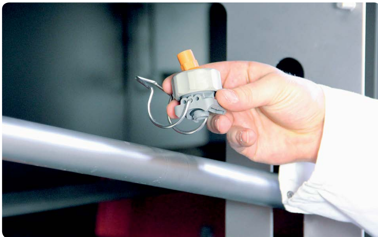
De EKW-5000, gemakkelijk nozzles afstellen en vervangen.
